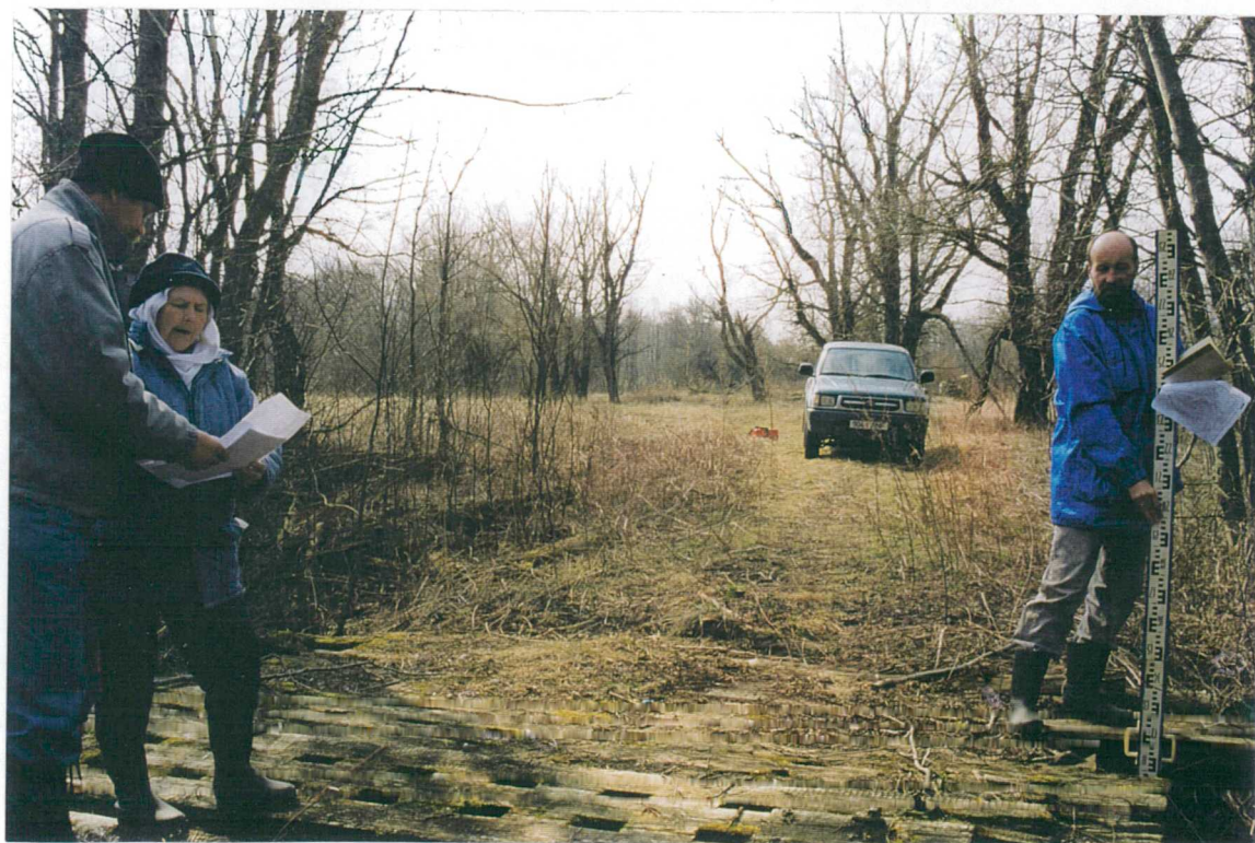
Joonis 11. Veetaseme mõõtmine Salajõel 2000.a. aprillis.
